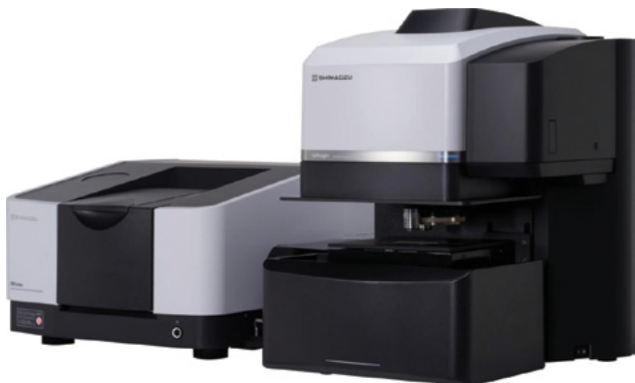
Fotografia 1. AIRsight – pierwszy na świecie mikroskop do jednoczesnej analizy w podczerwieni (FTIR) i spektroskopii Ramana, źródło: strona producenta [4].
